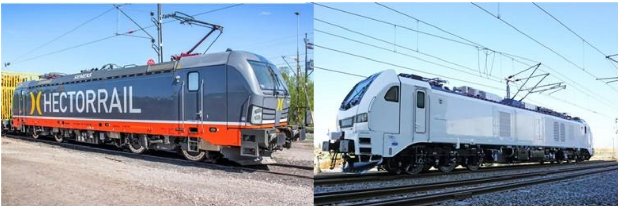
Figur 4.17: T.v: Siemens Vectron-lok som kom 2010 är både starkt och snabbt. Det kan dra ett tåg på 2500 ton och har en sth på 200 km/h. Foto: Christian Tellerup, järnväg.net. T.h: Stadlers Eurodual är ett hybridlok med både el- och dieseldrift. Det kom 2017 är 6-axligt och kan dra tåg på 3600 ton vid eldrift med en sth på 120 km/h.
