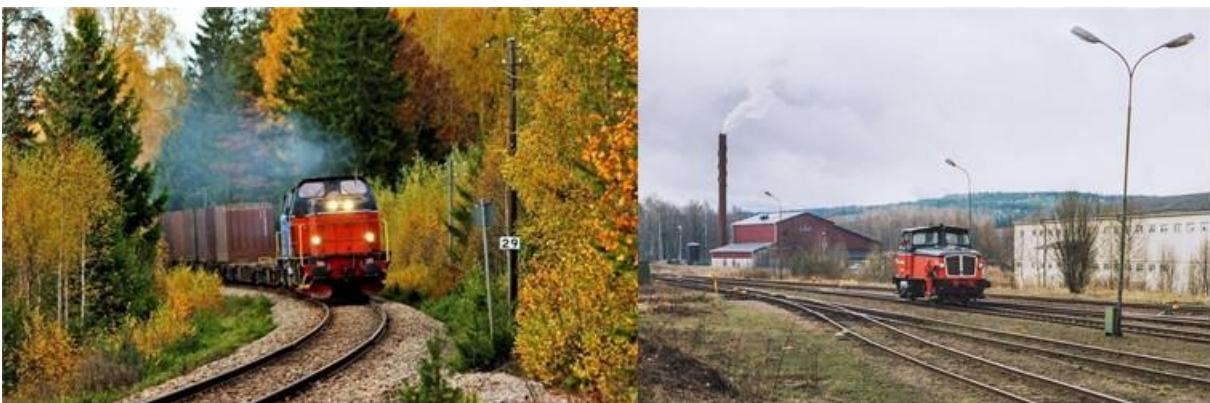
Figure 4.18: Det svenska dieselelektriska loket T44 kom 1967 och kan dra ett tåg på 1000 ton och har en sth på 100 km/h. Foto: Felix Hubertsson. Det svenska dieselloket eller lokomotorn Z70 används mest för växling och kan dra ett tåg på 500 ton och har en sth på 70 km/h. Foto: Christian Tellerup, järnväg.net.
