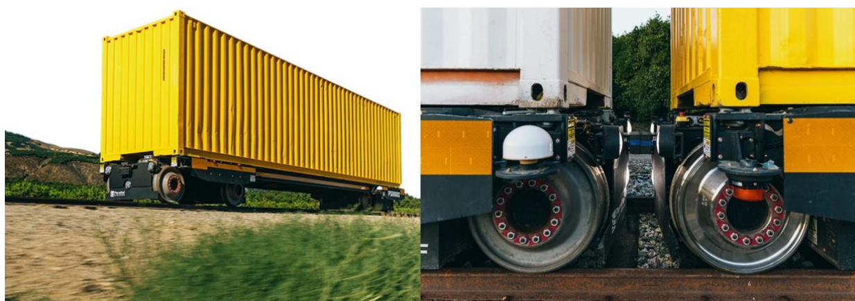
Figur 8.11: "Parallel Systems" Självgående vagnar med elektroniskt koppel som kan köra i tåg med upp till 50 vagnar utan lok och släppas av på vägen för växlas in på ett sidospår eller till en annan destination. Källa: Raitech.com 2024-01-05.
