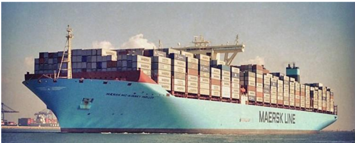
Figur 8.4: Båtarna kan vara mycket stora men containern är den minsta gemensamma nämnaren. Den vanligaste sjöfartscontainern är 2,44 m bred och 2,59-2,90 m hög och 12,1-13,7 m lång (40-45 fot). Detta fartyg är 400x59 m och lastar ca 9000 40 fots containers.
