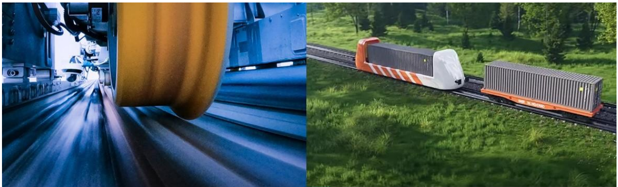
Figur 8.10: Newomo-tågets hjul svävar ovanför rälsen. Till höger Newomo-tåg med containers. Källa: Newomo.
