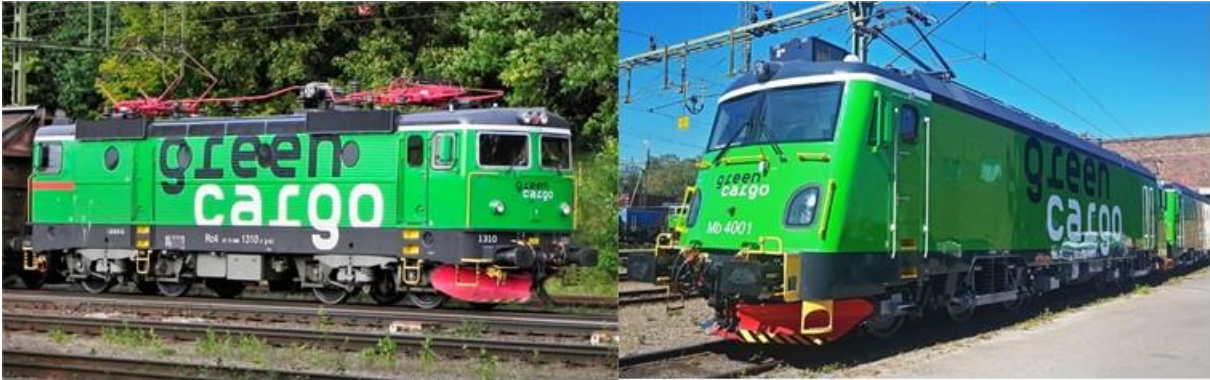
Figur 4.16: T.v. De svenska Rc-loken kom 1968 men gör fortfarande god tjänst. Rc4 kan dra ett tåg på 1650 ton och har en största tillåten hastighet (sth) på 135 km/h. Det används numera huvudsakligen i godstrafik. Foto: Felix Hubertsson, järnväg.net. T.h: Softronic Transmontana-lok kom 2018 och är ett 6-axligt lok som är nästan dubbelt så starka som ett Rc-lok. Det kan dra ett tåg på 3200 ton har en sth på 160 km/h. Foto: Green Cargo.
