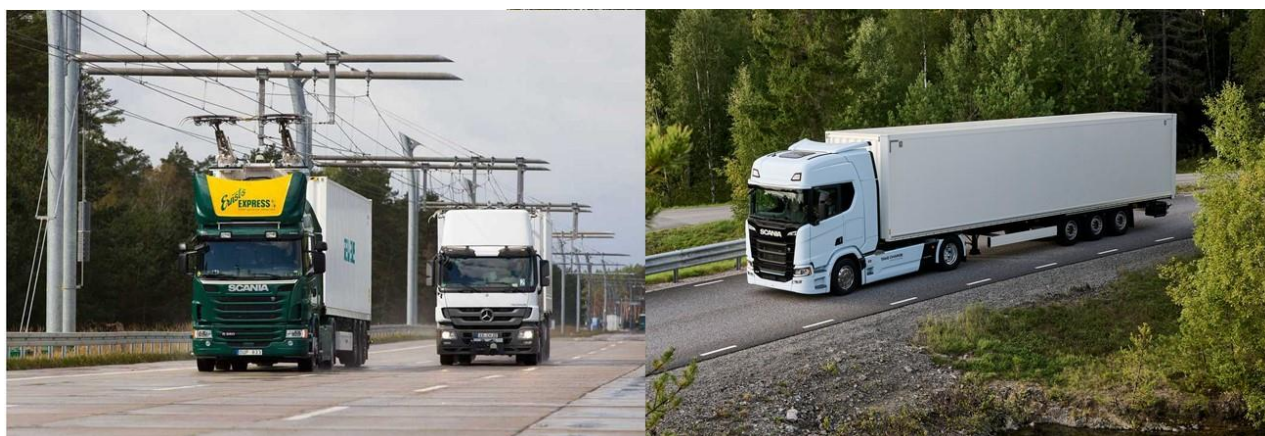
Figur 8.2: T.v. Ellastbil med kontaktledning mellan Gävle och Sandviken i ett svenskt försök. Bild: Siemens. T.h: Batteridrivna bil från Scania med 280 km räckvidd vid 40 tons bruttovikt. Bild: Scania.
