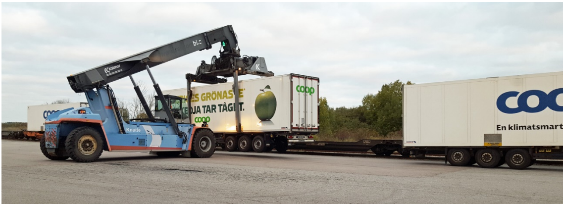
Figur 19. Kombitrafik, antingen med containrar eller som här lastbilstrailar som lastas på järnvägsvagnar för fjärrsträckan, är ett klimatsmart alternativ till direkt lastbilstransport. Foto: Emil Jansson
