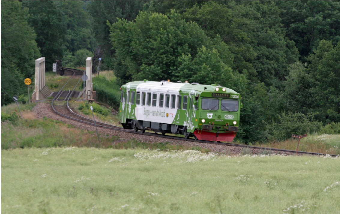
Figur 6. I mitten av 00-talet provades biogas som drivmedel i en ombyggd dieselmotorvagn på de oelektrifierade Tjust- och Stångådalsbanorna. Biogasen producerades och tankades i Linköping. Foto: Oskar Fröidh
